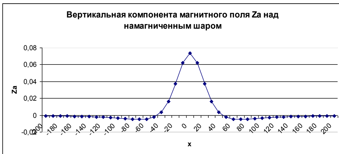
Рис. 5. График вертикальной компоненты магнитного поля Z_a над намагниченным шаром.
